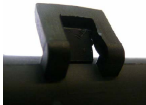
Lasche nicht vollständig eingerastet. Clip not completely locked in place.
