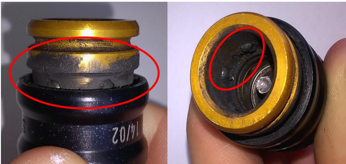
Es ist darauf zu achten, dass sich die fahrzeugseitige Kupplung in stets sauberem Zustand befindet und bei Bedarf geringfügig mit säurefreiem Fett instandgehalten werden muss.
